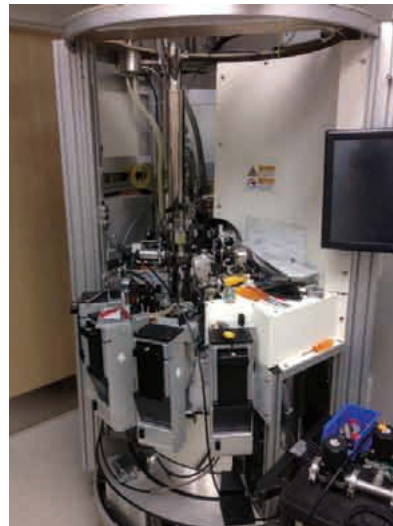
図 3 動的核偏極（DNP）による超偏極の誘導原理と臨床用 ^{13}\text{C} 核励起装置
