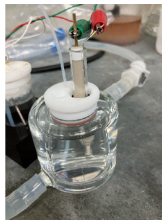
図1 測定に用いた電気化学測定セル
